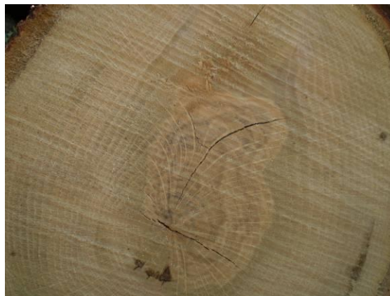
Foto 4. Diferenciación de madera de primavera y de verano
