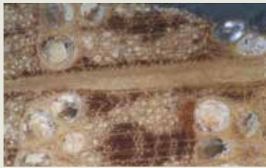
▲ Gaztainondo zura. Zeharka ebakia, 75X ▲ Madera de castaño. Corte transversal, 75X
