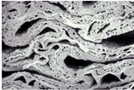
Microscopio electrónico. Izquierda: sistema celular de la madera. Derecha: paredes celulares colapsadas después de un secado defectuoso.
