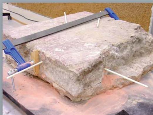
Zatiak zirien bidez finkatzea. Fijación de fragmentos con espigas.
